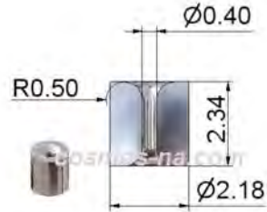
Part No. TR 034 Wt. 0.15 g Material: Tungsten carbide
