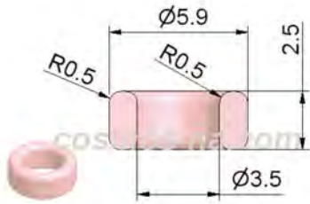
Part No. E 247 Wt. 0.13 g Material: 95 % Al 2 O 3
