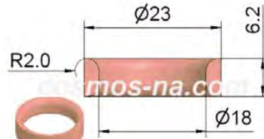
Part No. E 112 Wt. 3 g Material: 90 % Al 2 O 3
